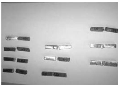
SLIKA 4 Izgled uzoraka za ispitivanje otpornosti na koroziju
