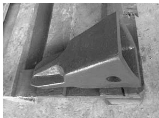
SLIKA 3 Probni odlivci izrađeni od NK3M čeličnog liva (isporučeni firmi APEX)
